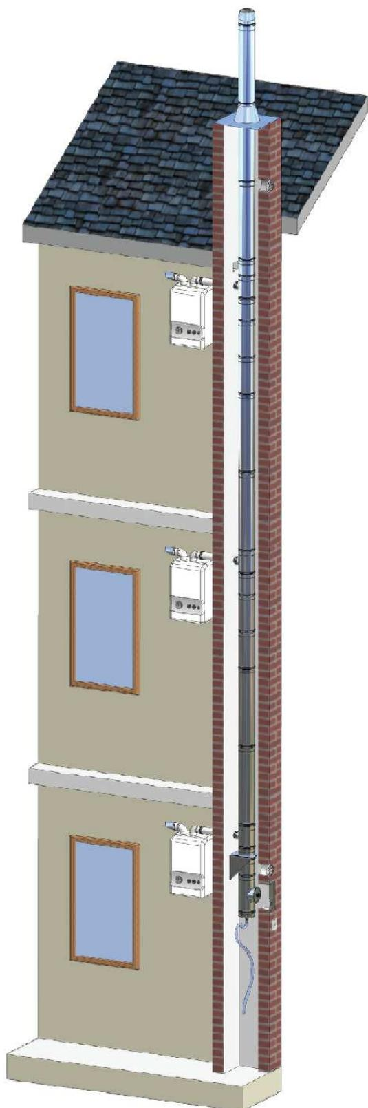
Negli edifici multipiano possono essere utilizzate canne fumarie collettive realizzate e dimensionate per funzionare in pressione negativa secondo norma UNI 10641 e UNI EN 13384-2.
